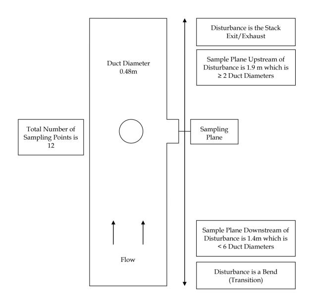
FIGURE F-1 CO-GENERATION ENGINE STACK – EPA ID NO. 7
